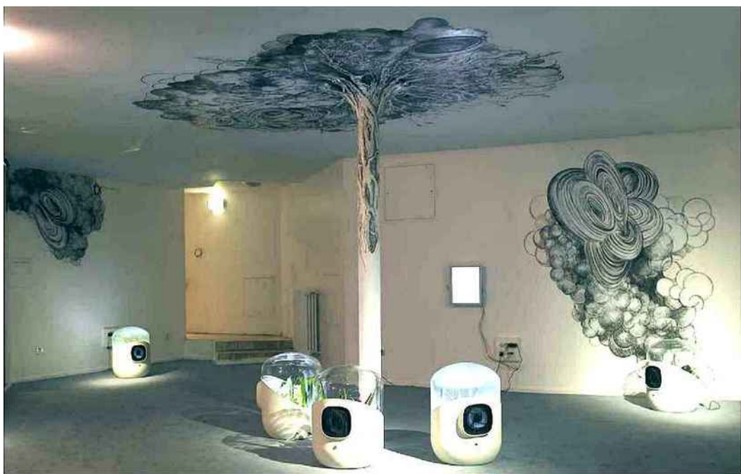
David Edwards, le scientifique, et Mathieu Lehanneur, le designer, ont conçu Bel Air, un filtre vivant pour l'habitat domestique. C'est un bac blanc, surmonté d'un dôme de plastique transparent sous lequel pousse une plante. Les feuilles, mais surtout les racines de celle-ci, absorbent les gaz toxiques et filtrent l'air.
